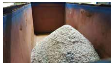
Un flux de polystyrène (broyat) issu du traitement de réfrigérateurs en fin de vie. Ce type de plastique est par exemple utilisé par la société Legrand pour faire des boîtes d'encastrement.
