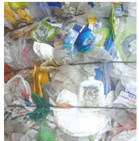
Une balle d'emballages ménagers en PEHD (PolyÉthylène Haute Densité) issus de la collecte sélective.
